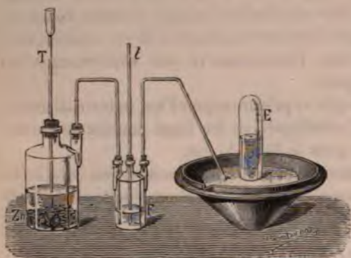
Fig. 124. — Préparation du deutoxyde d'azote.
